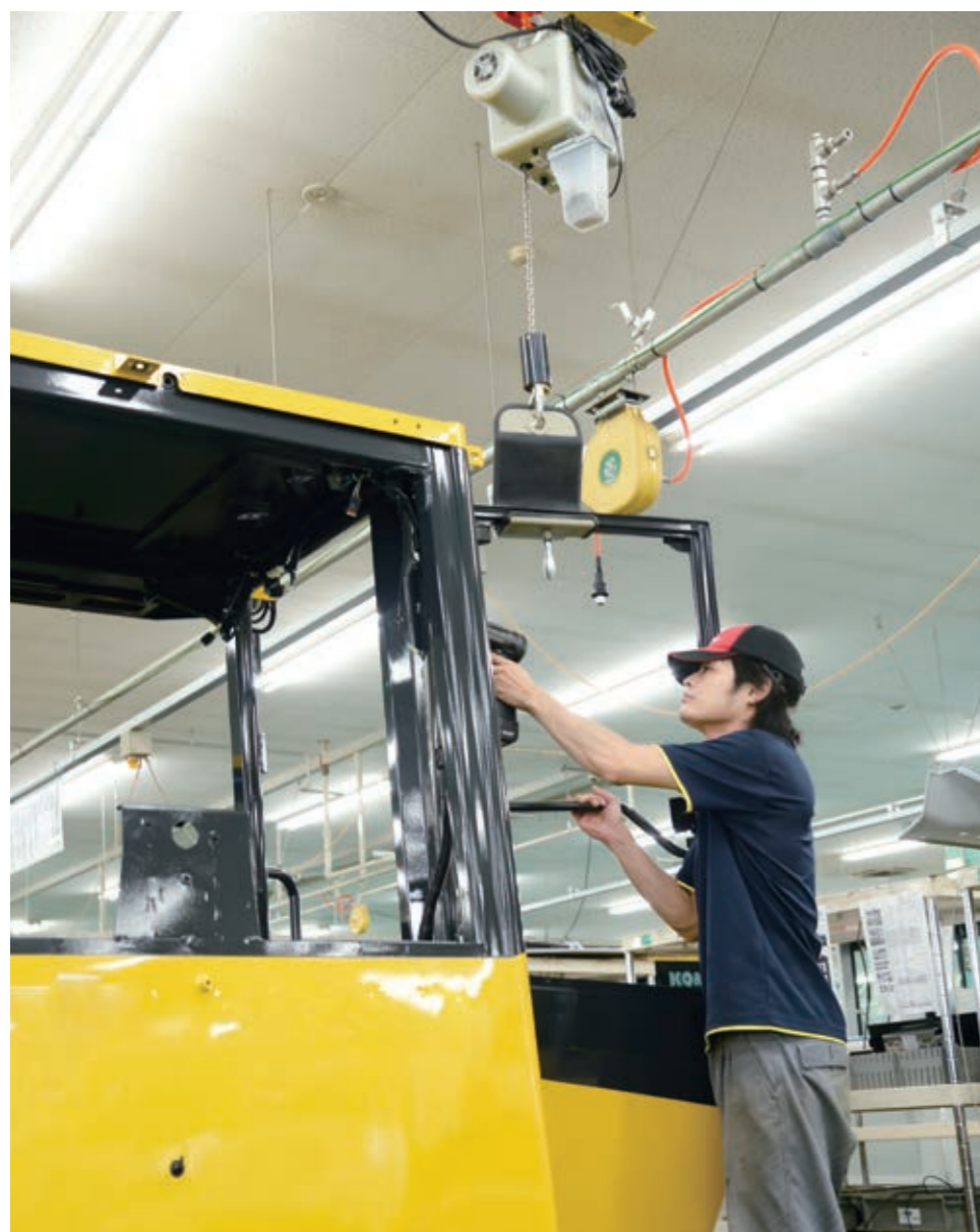
2人作業だったボルト締めが 1人でも可能に
